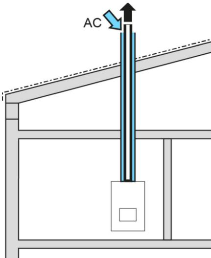
Amenée d'air de combustion directement à l'appareil de chauffage par un système indépendant de l'air ambiant (coaxial) reconnu par l'AEAI
