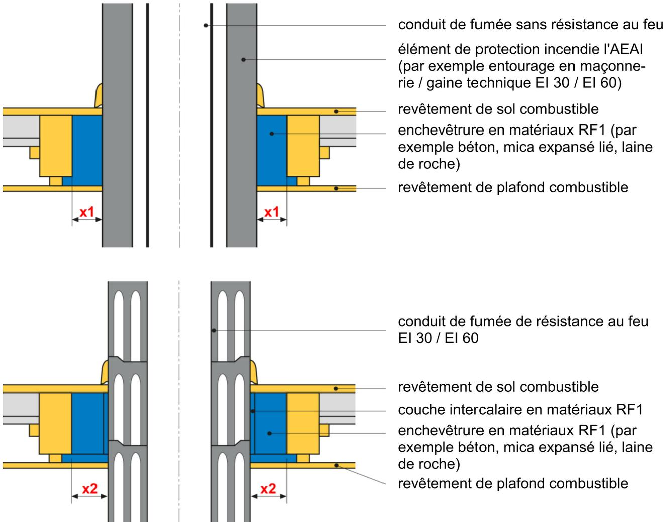
$x1 / x2$  = distance de sécurité requise jusqu'au matériau combustible, conformément aux données figurant sur l'attestation de reconnaissance AEAI ou sur le renseignement technique établi pour le conduit de fumée
