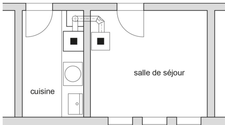
Les appareils de chauffage servant également à chauffer le local d'implantation peuvent être installés dans des locaux de construction quelconque.
