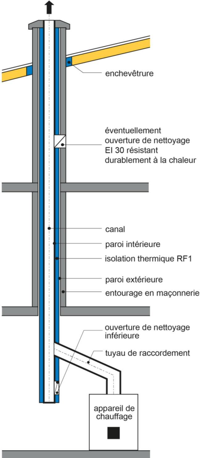
Exemple d'un conduit de fumée fonctionnant sous pression positive placé dans un élément de protection incendie (gaine)
