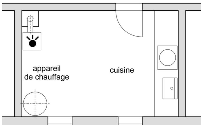
Les locaux ne sont soumis à aucune exigence quant à la construction et l'aménagement lorsqu'ils abritent des appareils de chauffage à combustibles liquides ou gazeux.
