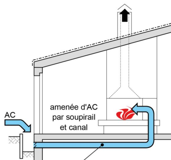
Les conduits d'air qui traversent sans ouverture d'autres compartiments coupe-feu doivent présenter la même résistance au feu que le compartiment traversé ou être munis d'un revêtement équivalent.
