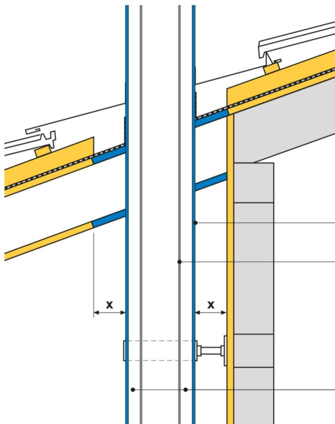
Le long de façades combustibles et pour la traversée d'avant-toits, les conduits de fumée en matériaux combustibles doivent être montés à l'intérieur d'un tuyau de protection en matériaux RF1 présentant une résistance mécanique suffisante.
