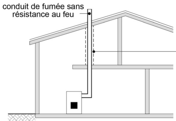
La distance de sécurité requise à l'étage supérieur par rapport aux matériaux combustibles doit, au besoin, être garantie par la pose d'une protection contre le contact accidentel en matériaux RF1 (tôle perforée, par exemple). Celle-ci doit résister durablement à la chaleur et ne doit pas entraver la circulation de l'air autour du conduit de fumée.
