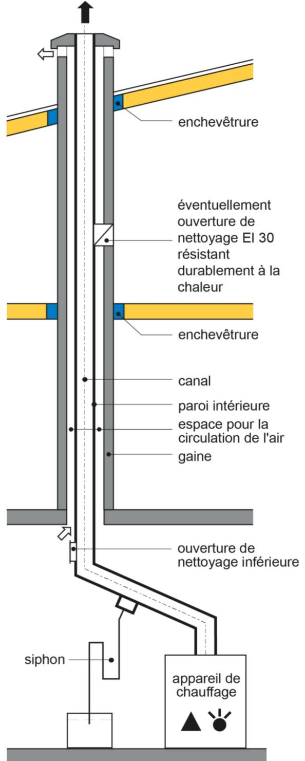
**Exemple d'un système indépendant de l'air ambiant (coaxial, classe T080) fonctionnant sous pression positive**
