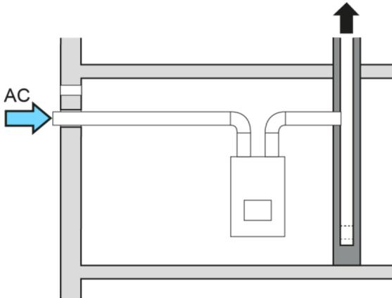
L'air de combustion est amené à l'appareil de chauffage directement de l'extérieur.
